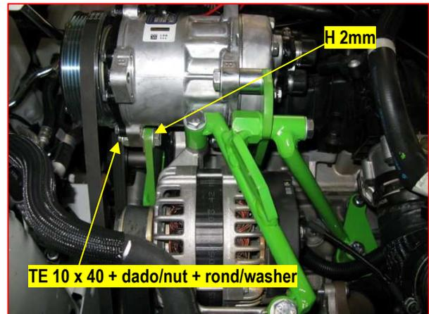
14. Montare la vite TE 10 x 55 + rondella e **BLOCCARE** tutti i bulloni fino ad ora installati (foto n. 9 e 10);
